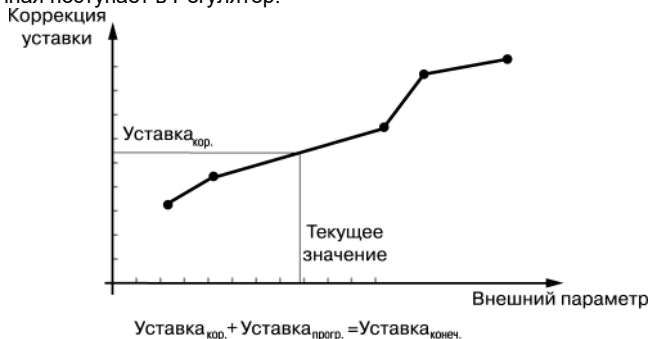
Рисунок 3.7 - Графики коррекции уставки
